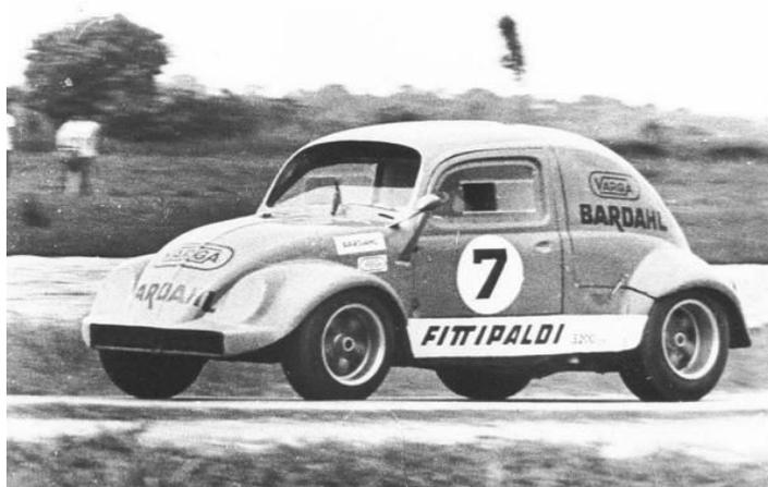
O Fitti-VW não terminou a corrida, quebrou o câmbio. Em 18 de novembro de 1970, correu em uma prova em volta do Estádio Mineirão, em Belo Horizonte. Dessa vez foi a junta de borracha Giubo - que unia os dois motores quebrada, um problema que se repetiu várias vezes.
